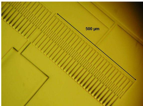
Fig 6. Embossing in PDMS layer on silicon
